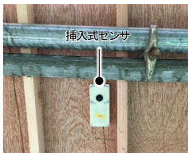
打込み時の評価に使用するセンサ (対象構造物：壁コンクリート)
