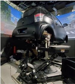
6自由度の運動が可能な6軸動揺装置にターンテーブルを付加した駆動装置
