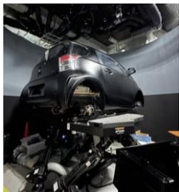
6自由度の運動が可能な6軸動揺装置にターンテーブルを装備したドライビングシミュレータ(DS)
