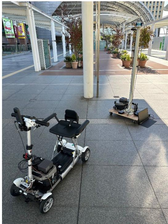
自動運転シニアカー(左)と LiDAR センサー(右)
